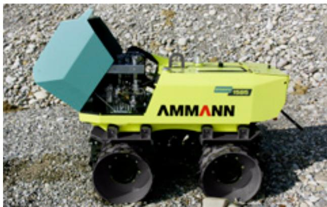
« LES CAPOTS S'OUVRENT LARGEMENT POUR PERMETTRE AUX TECHNICIENS DES ÉQUIPES DE MAINTENANCE D'ACCÉDER FACILEMENT AUX DIFFÉRENTS ORGANES DE LA MACHINE. »
