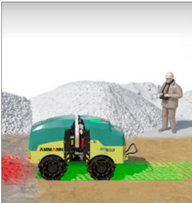
« COMMUNIQUE EN TEMPS RÉEL AVEC L'OPÉRATEUR PAR LE BIAIS D'UNE SÉRIE DE LED ET ÉVITE LES ÉVENTUELS SOUS/SUR-COMPACTAGES. »
