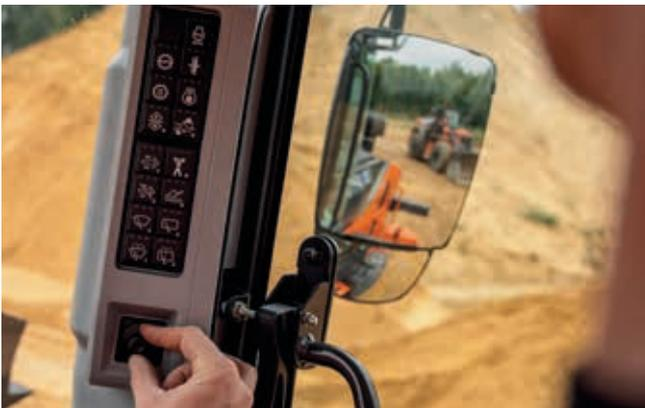
Le rétroviseur électrique réglable offre une bonne visibilité arrière.
